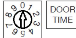
Задайте ID-переключателем код смещения физического адреса для верхней кнопки вызова (кнопка **0**) на модуле **1083/64M** или **1083/74M**
