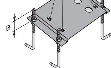
3. Отрегулируйте положение плиты с помощью гаек
